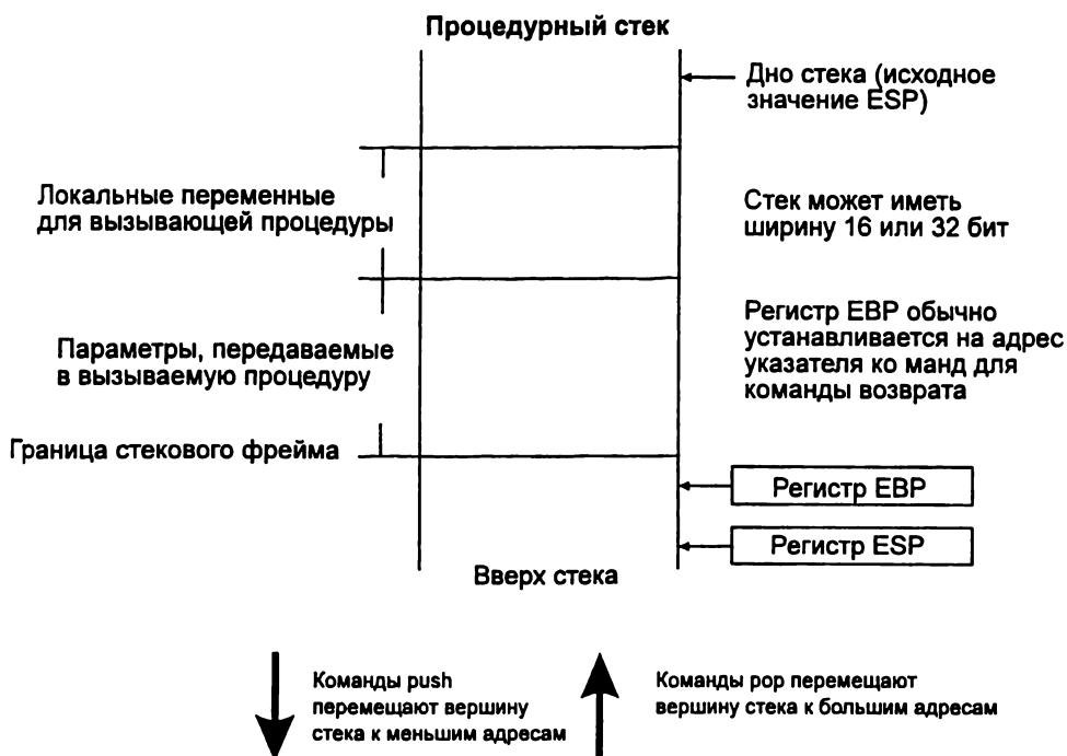
Рис. 3.7. Процедурный стек процессора Intel Pentium Pro (с любезного согласия корпорации Intel).
