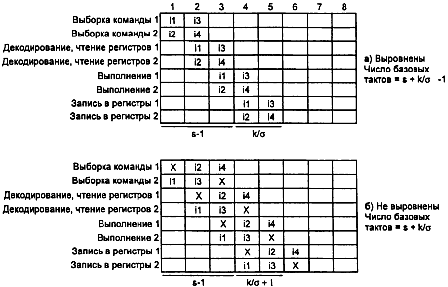
Рис. 6.20. Модель производительности суперскаляра.
