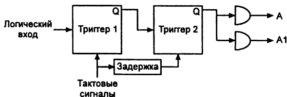
Рис. 7.23. Синхронизатор с уменьшенной интенсивностью отказов по причине метастабильности.
