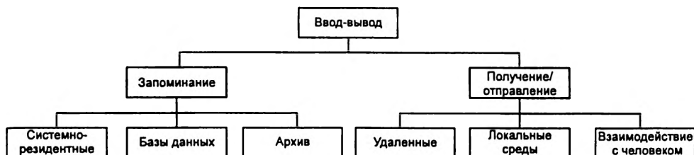
Рис. 7.1. Классификация устройств ввода-вывода.
