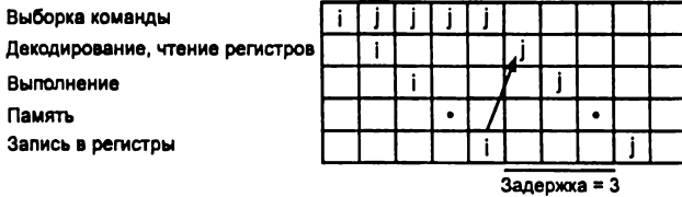
Рис. 6.14. Взаимозависимость типа RAW.
