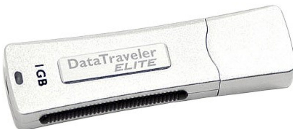
Рисунок 2 FLASH-накопитель Kingston DataTraveler Elite с поддержкой программно-аппаратного шифрования данных
