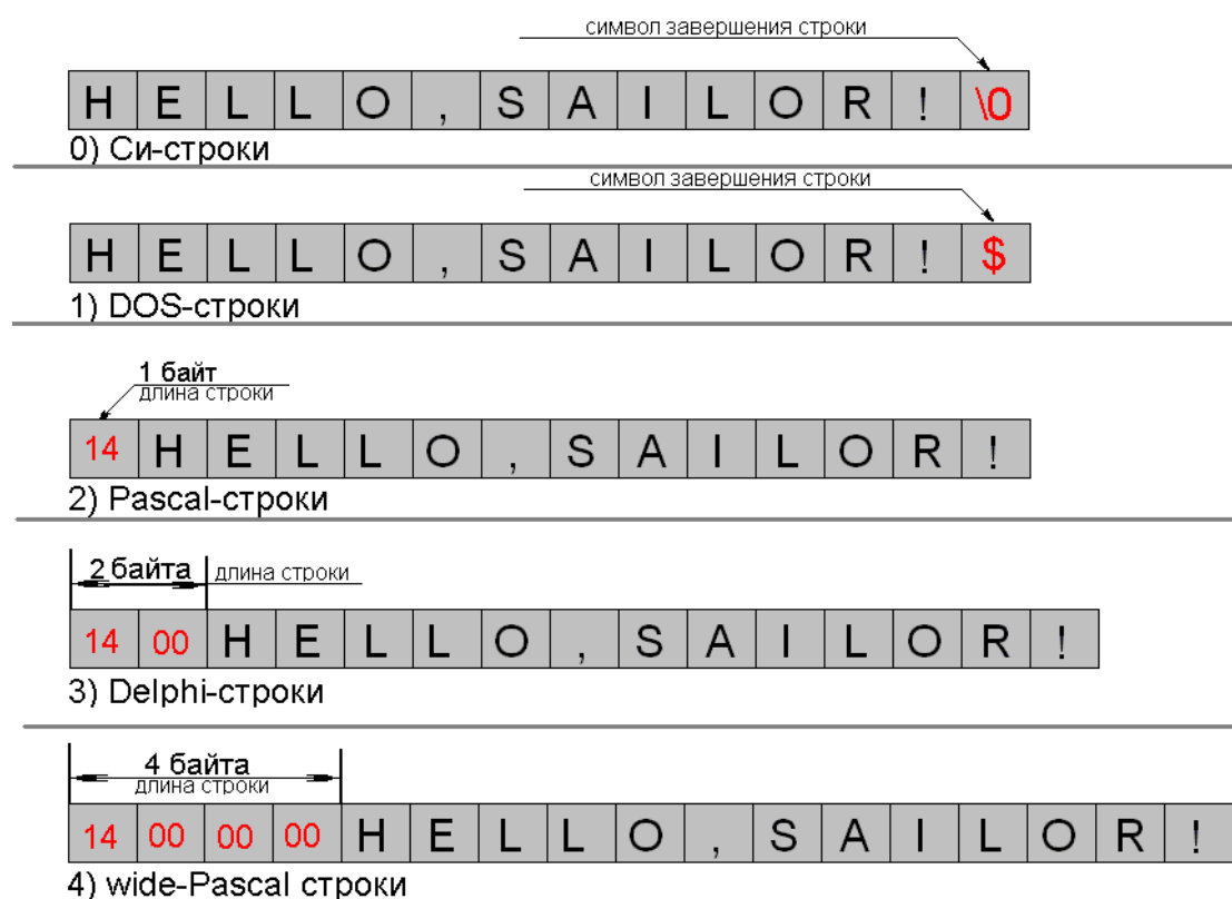
Рисунок 5 "устройство" строковых переменных различных типов
